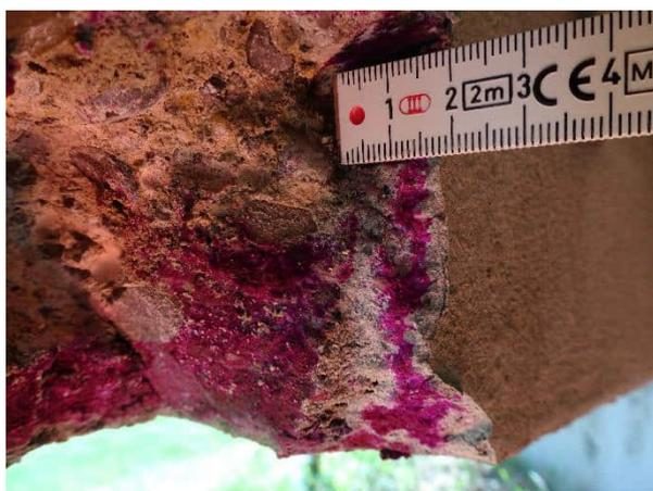
Abbildung 21 Gut sichtbar ca. 2mm karbonatisierter Reprofiliermörtel
