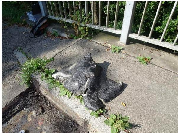
Abbildung 14 PBD Abdichtungsstück im Bereich der Belagssondage
